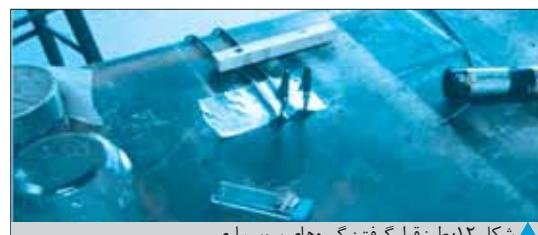
شکل ۱۲: طرز قرار گرفتن گیرهای سوسماری
